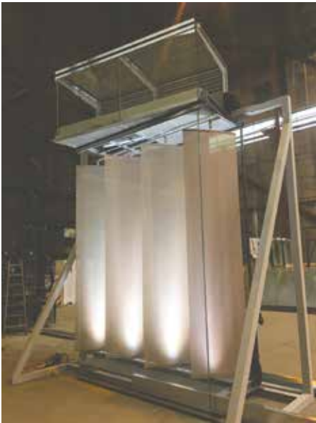
Hver lamel af fibersvejste, udspændte nylonfibre er mellem 800 og 900 mm brede. De længste er 5200 mm.
