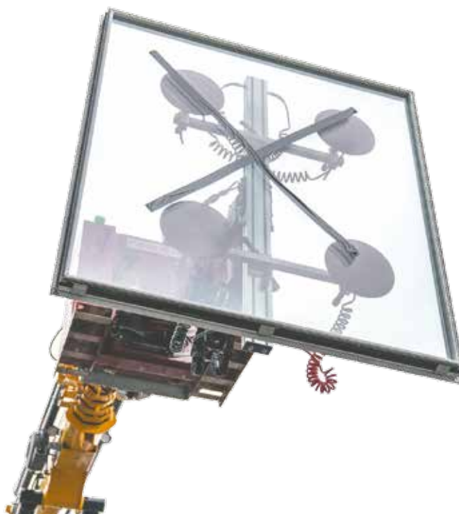
Gerunuk-robotten er monteret på en byggekran og kan fra jorden arbejde i op til 57 m højde. Det betyder præcise løft selv på højhusbyggeri.
