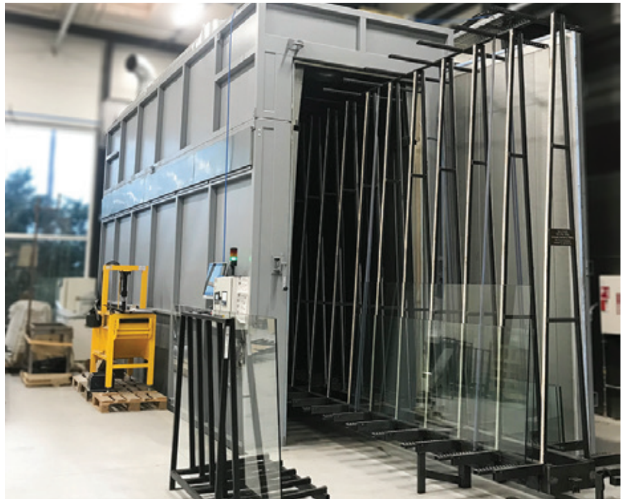
Med en heat soak-testmaskine kan Glaseksperten nu levere glas med yderst lav risiko for brudfremkaldende nikkelsulfid.
