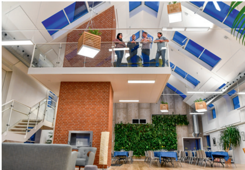
Taget er med 50 procent glasfelter og resten med fyldningspaneler.
