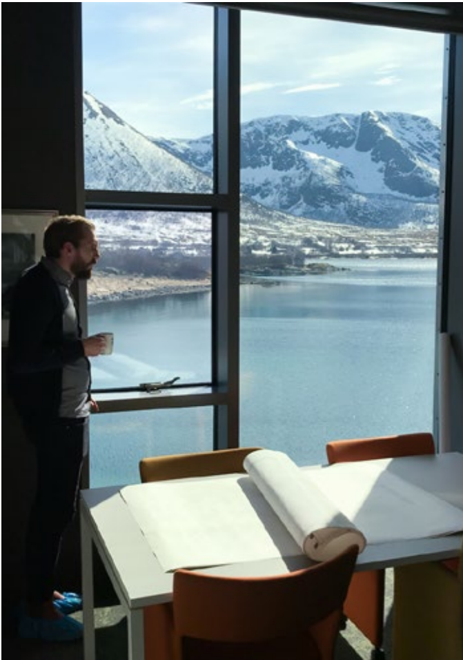
Når der ikke er behov for solafskærmning, er glassene lyse og gennemsigtige som almindelige ruder.
