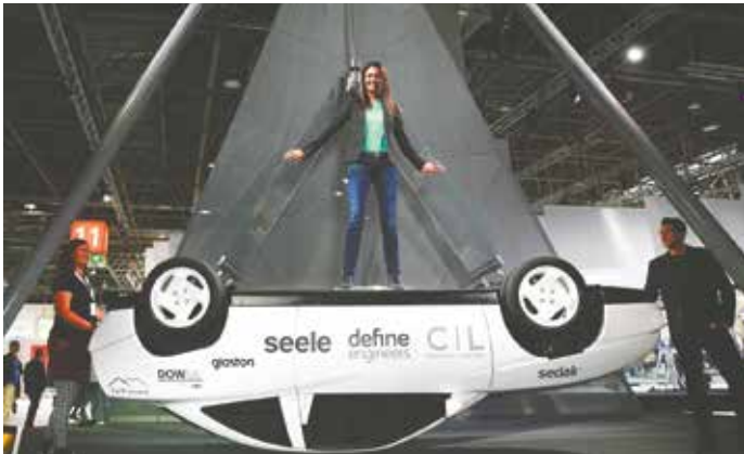
Kan man hænge en bil op i to stykker hærdet, lamineret tyndglas? Ja, det kan man, lød svaret fra Seele og Dow. Foto: Seele.
