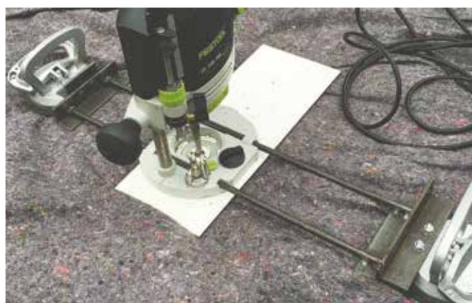
Det specialudviklede værktøj til opgaven, hvor overfræseren blandt andet er blevet udstyret med en 3d printet sål, som kan centrere fræsejernet.
