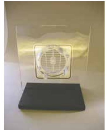
Ventilatorens jalousi hæftes midlertidigt fast på ruden via to klemmen.
