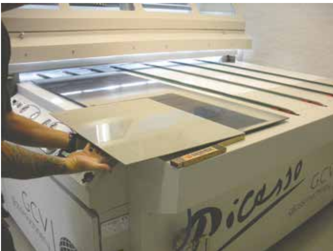
Ved at lægge et ekstra stykke glas under det glas der skal males, kan maskinen også male meget små stykker glas.
