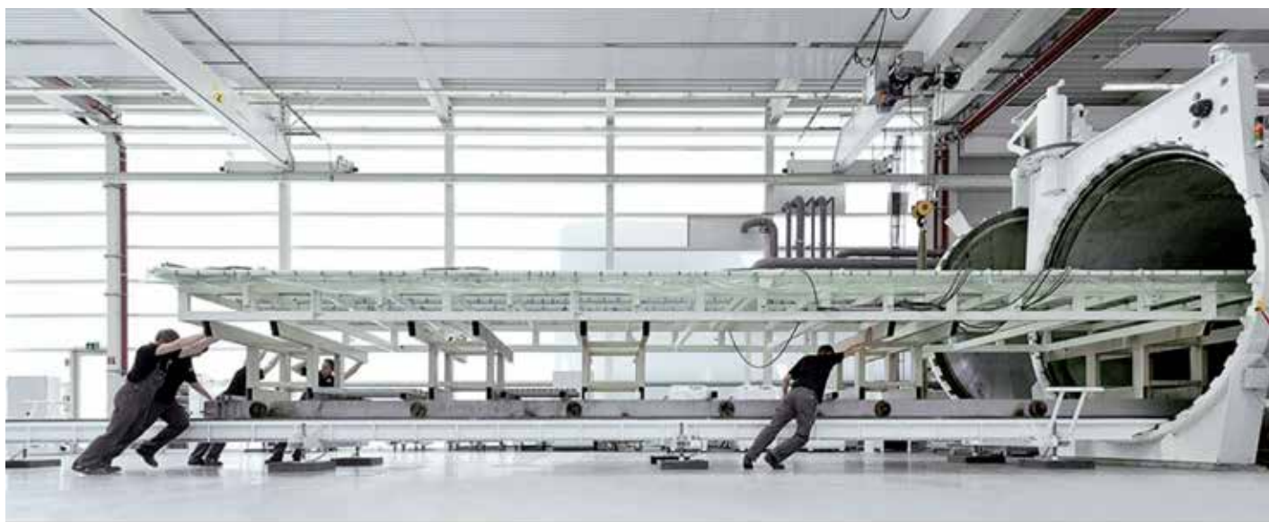
Autoklaver, der kan tage de helt store formater, er her allerede. Foto fra professor Mikkel Kraghs indlæg på Glas-, Vindues- og Facadedagen 2017.
