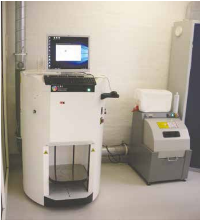
Malingen blandes på værkstedet, og der kan blandes op til 15.000 forskellige farver i både RAL og NCS.
