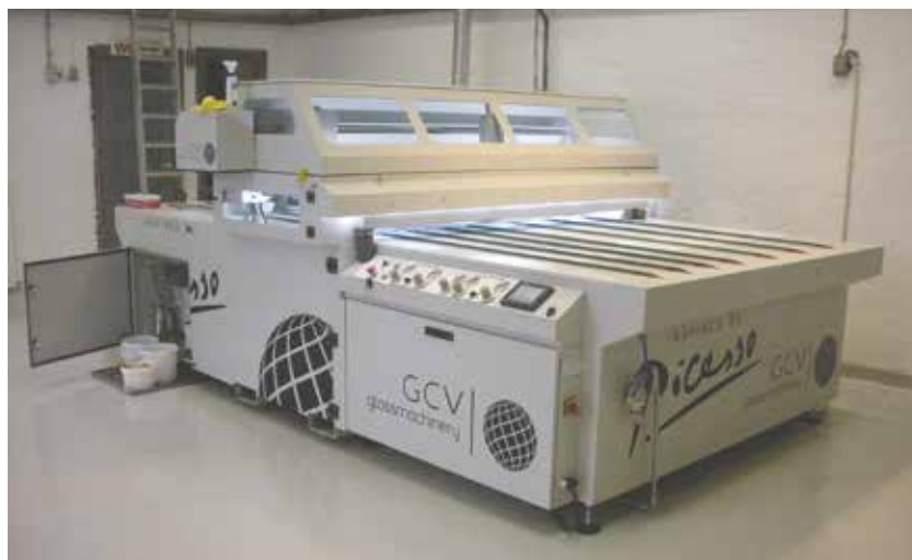
I venstre side af maskinen er indbygget et skab hvor malingen kan sættes ind.
