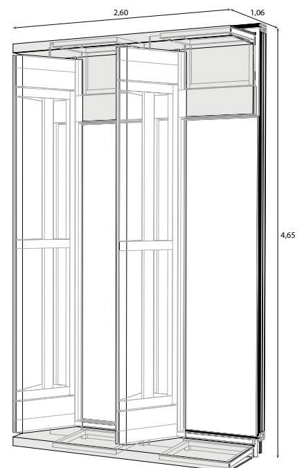
Axiometri af skodderne, der her ses åbne, men kan lukkes delvis eller helt hen foran facadens ruder. Tegning: Waagner Biro Stahlbau AG.
