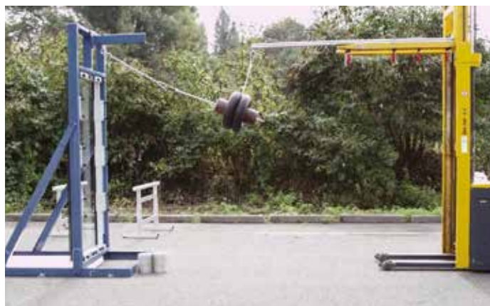
Sikkerhedsglas med film afprøves med slagtest.
