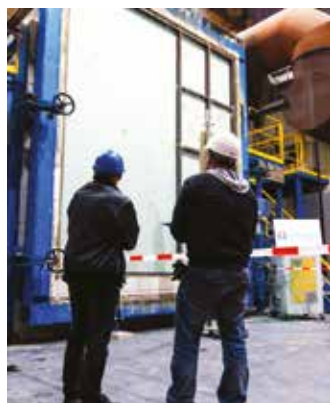
Contraflam Mega før og efter brandtest. Varmen har fået interlayeren mellem glasslagene til at blive uigennemsigtigt og fungerer som varmeskjold.
