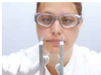
Tyndt glas får stadig større anvendelse og kan laves ned til 25 mikrometer. Det er således tyndere end et menneskehår.
