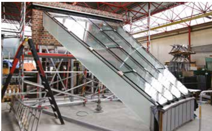
Dobbelkrumt kold-bøjet glastag - glassets 2-lags ruder er limet til bærende glasfinner. Mock-up, Victoria & Albert Museum.
