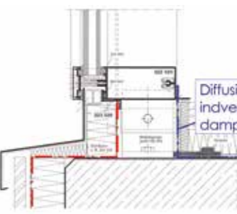
5. Korrekt tætning ved bundtilslutning.
